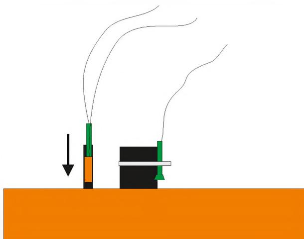
В погружную гильзу вначале опускается датчик центрального отопления (датчик ЦО), а за ним датчик термозащиты (термик). Как вариант, допускается установка датчика термозащиты на патрубке подающего трубопровода котла (до гайки подключения), при этом, прижатие его к патрубку должно выполняться металлическим хомутом. Добавление каких-либо жидкостей в погружную гильзу запрещено!
