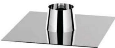
Элемент предназначен для герметичного и безопасного прохода трубы дымохода через кровлю на улицу. Используется для плоской кровли. Предотвращает от попадания осадков или мусора в чердачные помещения
