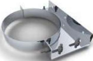
Элемент используется для крепления дымотрубной системы к стене на расстоянии в пределах регулировки до 50 мм до стены. Элемент, поддерживающий трубу дымохода в заданном положении и обеспечивающий устойчивость при боковых нагрузках. Не несет вертикальной нагрузки. В случае отдаления дымохода от стены на расстояние более 50мм для удлинения используется элемент дымохода: Удлинитель стенового хомута.
