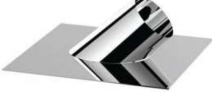
Элемент предназначен для герметичного и безопасного прохода трубы дымохода через кровлю на улицу. Используется для скатной кровли с углом от 5-20°. Предотвращает от попадания осадков или мусора в чердачные помещения
