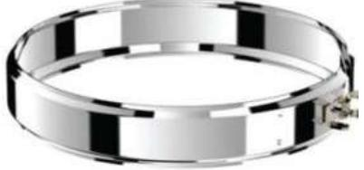
Элемент для дополнительной фиксации и стяжки стыков дымоходных труб между собой. Элемент предназначен для создания герметичности и обеспечения прочности дымотрубной системы. Края стягиваются с помощью болта и гайки.
