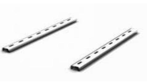
Удлинитель кронштейна L=500 (максимальное удлинение до дымохода 250мм), S235JR 4мм
