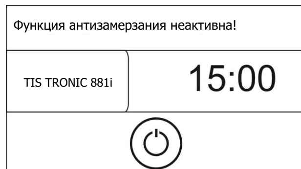
Рис. 8 Вид экрана контроллера в выключенном состоянии (режим STAND-BY), в котором функция антизамерзания неактивна.
